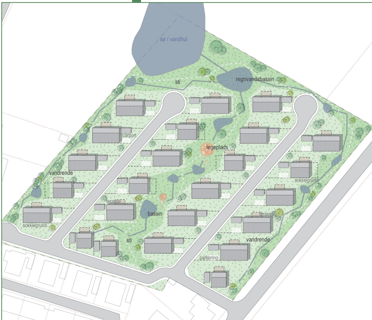
Illustrationsplan: Bebyggelse på sokkelgrunde med et fælles grønt landskab imellem de enkelte boliger. Overfladevandet fra bebyggelsens tage ledes via åbne vandrender gennem fællesarealerne, og indgår som et rekreativt element.
