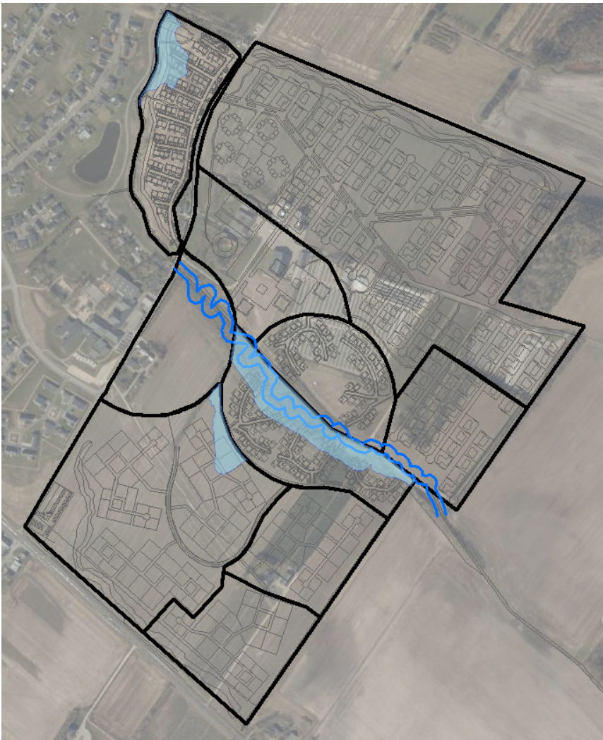
Figur 10: Områder hvor der skal terrænreguleres vist med blå flader. For det nordøstlige hjørne skal terrænet reguleres til kote 21,55. For den midterste flade skal terrænet reguleret til kote 25,0. For den sydligste flade skal terrænet reguleres til kote +27,6. Alle koter i DVR90.
