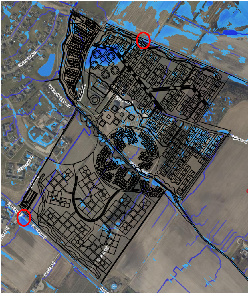
Figur 12: Eksisterende strømningsveje med oplandsareal større end 1 ha samt bluespots ved 60 mm regn. Indløb af udefrakommende strømningsveje vist med røde cirkler.
