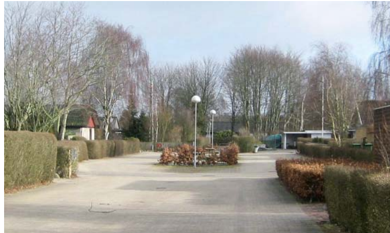
Eksempel på en sekundær boligvej, hvor der skal anvendes et armatur med symmetrisk lysfordeling for at give den mest optimale belysning af begge vejstykker
