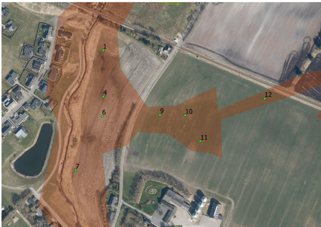
Figur 6: Oversigtskort for planområde 1 med lavbundsarealer/okkerklassificering (okkerklasse I) og placering og nummerering af håndboringer. Ortho: 2020.
